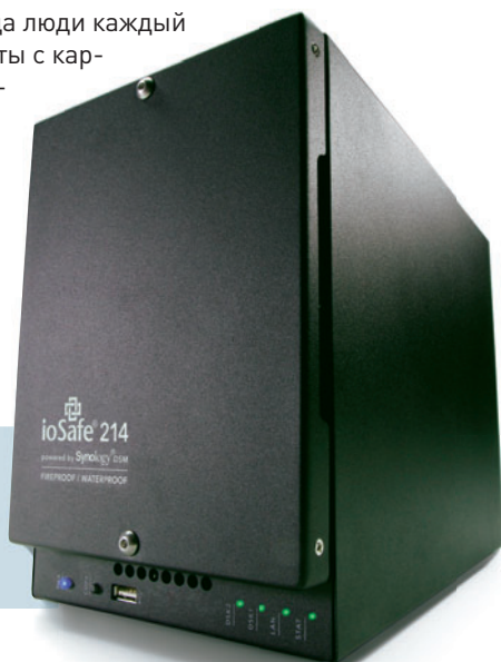
Устройство NAS ioSafe 214 обладает повышенной устойчивостью к воздействию огня и воды
